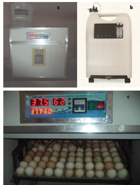
Figura 1. (a) Tipo de incubadora XM-18D utilizada en el experimento. (b) Concentrador de oxígeno OLV-10-MD que se conectó a la incubadora para proveer oxígeno adicional. (c) Panel de control de temperatura y humedad que indica las condiciones ambientales a nivel de la bandeja de incubación
